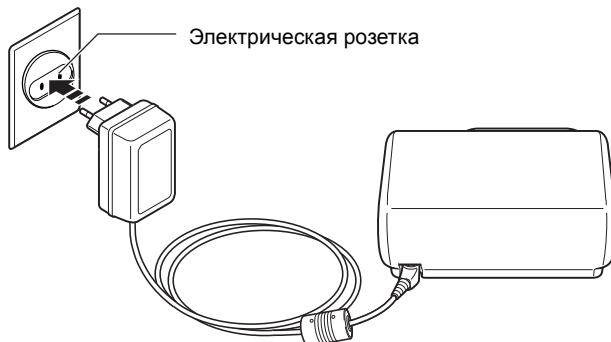
**Примечание:** При отсоединении адаптера переменного тока отключите его от электрической розетки, прежде чем извлекать разъем питания из компрессора.
