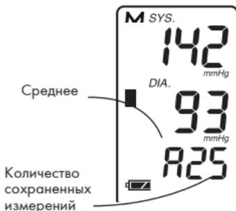
Прибор UB-202 может автоматически сохранять до 90 измеренных значений артериального давления и частоты пульса. Результатам измерения, сохраненным в памяти, присваиваются порядковые номера (от первого по хронологии, до последнего). Первый сохраненный результат имеет порядковый номер «1» и отражается на дисплее как "n01".
